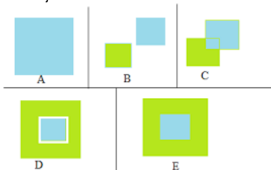
Gambar 3. Occlusion Yang Terjadi Karena Interaksi Antar Objek (A)None (B)Proximity (C)Intersection (D)Enclosurement (E)Containment
