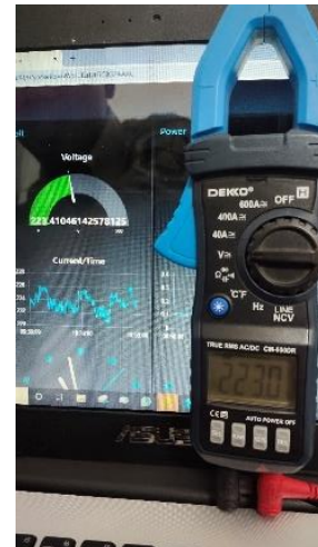
Gambar 6. Hasil pembacaan tegangan dari sistem dan AVOMeter
