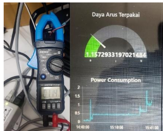
Gambar 7. Hasil pembacaan pengukuran arus dengan sistem dan AVOMeter
