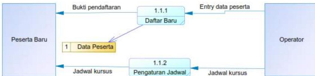
Gambar 3.4 Data flow diagram level 2 sub process Pendaftaran peserta baru
